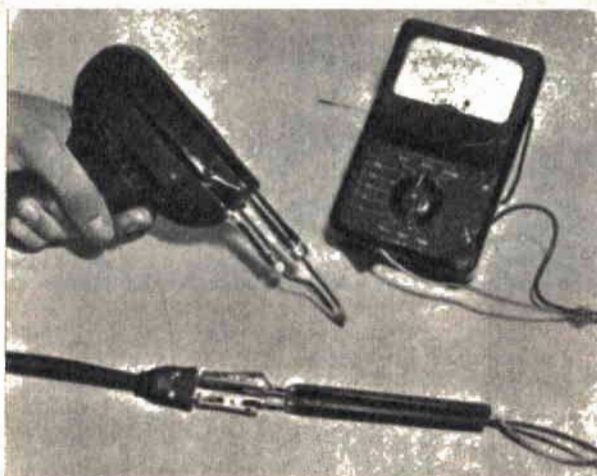
Fig. 1 - La punta lunga e sottile del saldatore rapido permette di accedere nei circuiti più intricati, senza che il calore rovini le parti circostanti al punto dove si effettua la saldatura.
